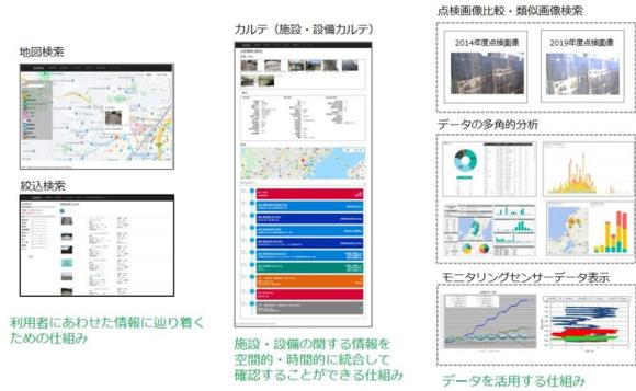
SIMPLの基本機能は、PCだけでなく、タブレットやスマートフォンといったモバイルデバイスでも利用することができます。事務所での総合的な管理では、様々な条件を組み合わせデータ抽出して分析したり、報告用の帳票を作成したりすることができます。現場での維持管理では、点検現場への移動中に周辺の情報を確認したり、点検作業中に過去の補修情報から詳細な情報を確認したりすることができます。
